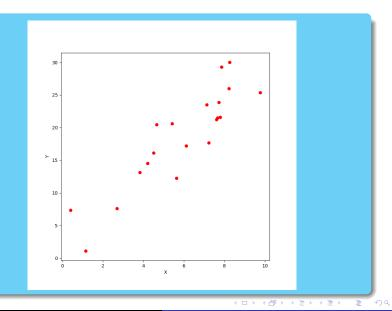
• debido a las diferentes escalas y unidades es conveniente renormalizar los datos con su valor medio y desviación standard. Si tenemos una muestra  $x_1', x_2', \cdots, x_N'$  se renormaliza con  $x_i = \frac{x_i' - \bar{x}'}{s}$ .
